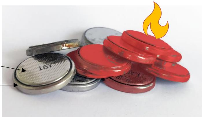
Par simple contact, s'il reste encore de l'énergie résiduelle, des courts-circuits peuvent se créer très facilement!
