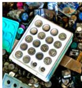
Pour les piles bouton il existe des barquettes conçues spécialement pour les isoler les unes des autres. A empiler ensuite dans un carton.
